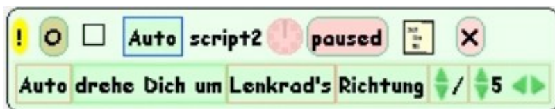
Abbildung 13: Das Auto soll sich nur um einen Bruchteil des Lenkradausschlags drehen. Das Auto lässt sich nun wesentlich leichter manövrieren.
